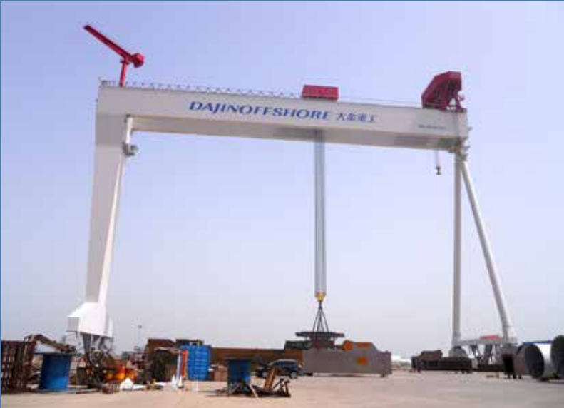
▲ 1600t 造船门式起重机型式试验
